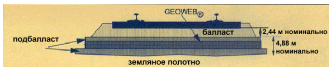
Рисунок 4. Строительство рельсового пути с применением ячеистой ограничивающей системы Geoweb®, спроектированной для восприятия смещений земляного полотна без нарушения целостности конструкции
