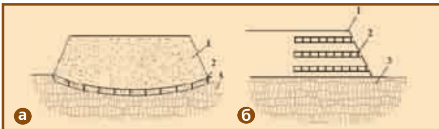
Рис. 4. ИСПОЛЬЗОВАНИЕ ГЕОВЕБ® ПРИ АРМИРОВАНИИ НАСЫПИ
